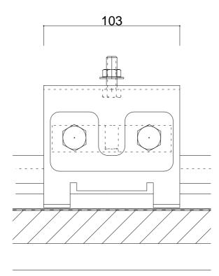
丸桟・角桟共通部品 母屋列上部取付基準でのPV金具配置をお願い致します。 屋根本体へのPV金具取付トルク16N・m (状況により15~17N・m目安に調整)
